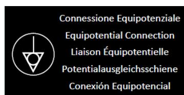
**EQUIPOTENCIAL** El aparato debe conectarse en un sistema equipotencial. Realice la conexión mediante el terminal suministrado y marcado en el lateral del aparato con el símbolo internacional en la figura.
